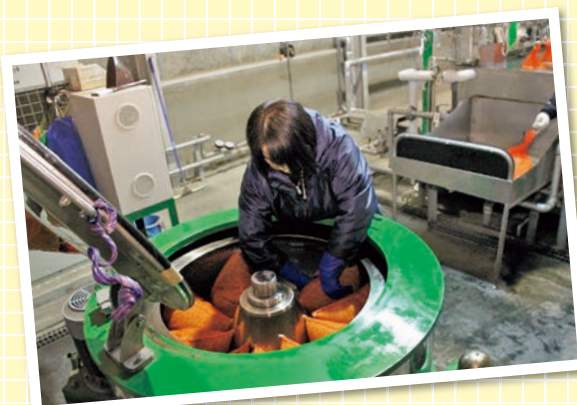
▲冷却後は脱水機で4分弱脱水する
