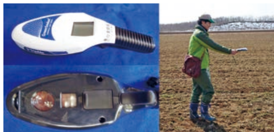
写真2 生育センサ(左)と使用の様子(右) 植物が、赤・青色を吸収、緑色を反射する性質を利用。 機器が発光し、その反射で数値を出し、莖数を推定する。
