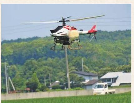
厚真町上野地区にある水田で無人ヘリコプター水田防除が委託業者によって行われている様子。6月下旬から8月上旬にかけて3度散布されたうち2度目の散布写真。操縦には免許が必要なため業者へ委託しており、オペレータ2人により散布される。
